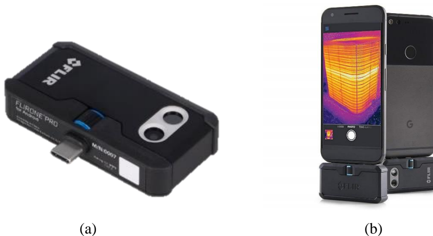
Figure 21: système d'acquisition ; (a) la caméra FLIR ONE Pro, (b) la caméra FLIR ONE Pro connectée à un smartphone
