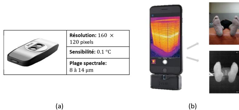
FIGURE 3 – Système d’acquisition d’images : (a) Caractéristiques de la caméra FLIR ONE Pro, (b) FLIR ONE Pro connectée à un smartphone, affichant une image thermique et une image en couleur (à droite).
