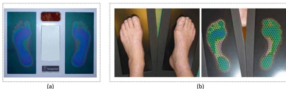
FIGURE 1.5 – Technologie de mesure thermique : (a) TempStat et (b) SpectraSole Pro 1000.
